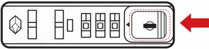
ダイヤルをセットし、点線部分のボタンを矢印の方向に
